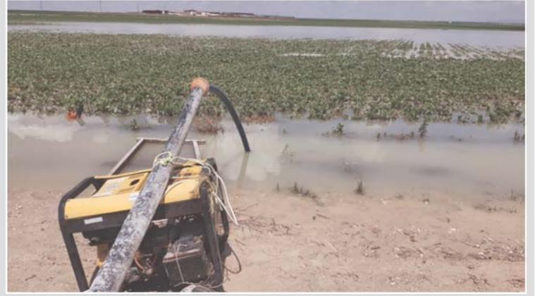
Günlerdir yağın ve tarlalarda küçük göletler oluşturan yağmurlar motorlar kurularak tarla dışına atılıyor. İlçenin bir çok mahallesinde çiftçiler suları bu yöntemle boşaltmaya çalışıyor. Çiftçiler tarlaların içerisinde borular monte ederek suyu motor vasıtası ile boş alanlara
